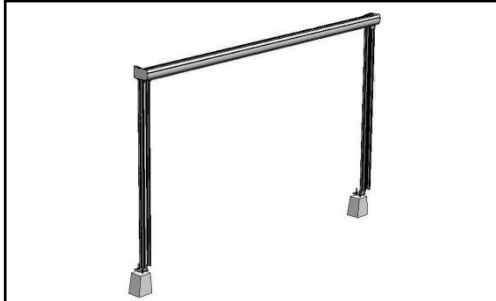
Abbildung 11, Aufrichten der Bodenstützen mit Rinne
