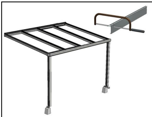
17, Anbringen der Träger / Zurechtsägen der beiden Abdeckprofile
